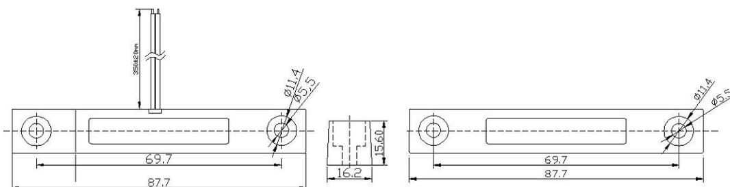
Извещатель магнитоконтактный ST-DM135NC-WT предназначен для контроля положения различных строительных конструкций (дверей, окон, люков, ворот и т.д.). Данное устройство может использоваться в системах охранной сигнализации или контроля и управления доступом.
